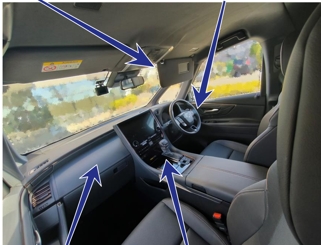
インストルメントパネル ：TPOシート・TPO複合材 ・加飾フィルム
